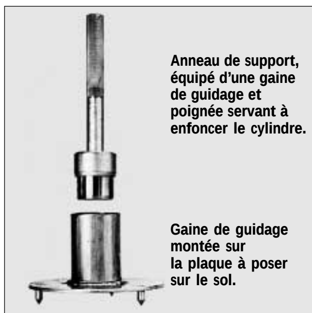
Fig. 48 : L'illustration représente un équipement d'échantillonnage de 100 ml.
