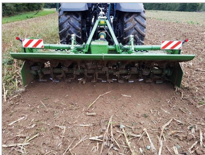
Mise en route d'une fraise scalpeuse permettant un travail du sol superficiel directement dans des résidus de cultures ou des couverts végétaux, photo AgriVulg
