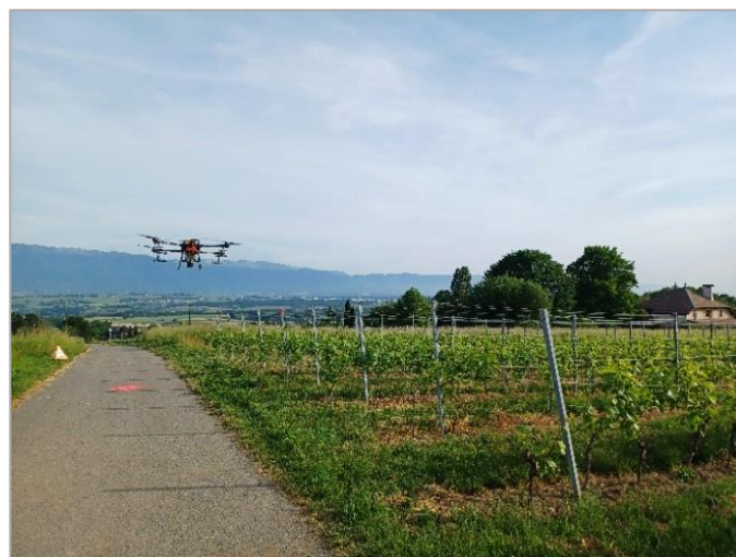
Essai pulvérisation au drone (3 hauteurs différentes), Vignoble de l'Etat 2022, photo AgriVulg
