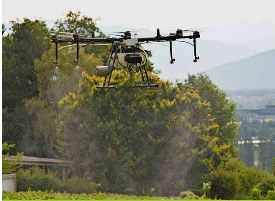
Doté de huit hélices et de quatre buses, le drone en pilotage automatique se maintient de 2,6 à 3 mètres au-dessus du sol selon la pente.
